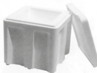
Cassaforma in polistirolo per provino cementizio
