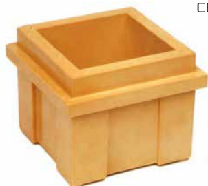
Cassaforma in poliuretano per provino cementizio
